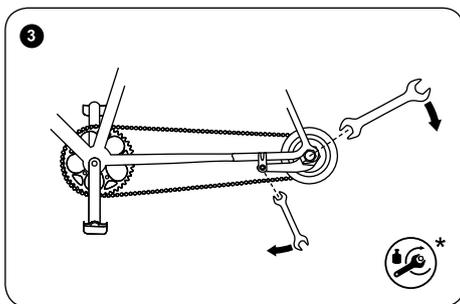
**i** Sporczia e sollecitazioni permanenti possono danneggiare la catena che dovrà essere sostituita non appena risulta possibile sollevarla (circa 5 mm) sopra la ruota dentata anteriore. Numerose catene moderne per sistemi di cambio a deragliatore non dispongono più di connettori di giunzione apribili. Pertanto, per aprire/modificare/chiedere le maglie occorrono strumenti specifici. Questa operazione deve essere svolta da un rivenditore specializzato.
