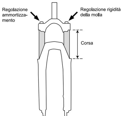
Le forcelle ammortizzate devono essere regolate in conformità alle istruzioni fornite dal produttore della forcella. Generalmente, la forcella dovrebbe “comprimersi” quando si pedala su superfici irregolari, senza raggiungere il fine corsa.
