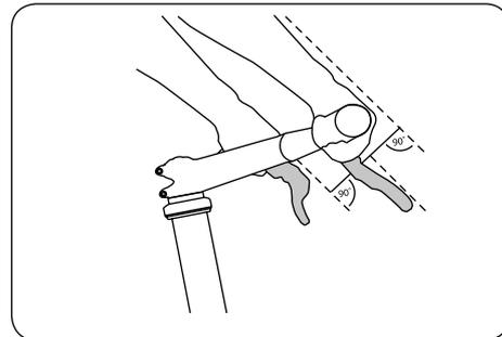
Per aiutare i ciclisti con le mani più piccole ad azionare i freni, le leve possono essere avvicinate al manubrio mediante una vite di regolazione (presente sulla leva).
