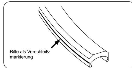
**i** Die Felgen sind hoch belastete und sicherheitsrelevante Bauteile. Durch Fahrbetrieb, besonders durch Felgenbremsen, verschleßen sie. Wenn Sie Beschädigungen sehen oder Verschleißmarkierungen Abnutzung anzeigen, fahren Sie nicht mehr mit dieser Felge. Lassen Sie sie durch einen Fachhändler überprüfen und austauschen.
