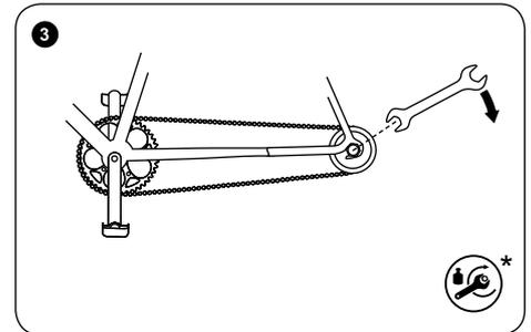
**i** Schmutz und dauernde Belastung verschleßen die Kette. Sobald man sie mit den Fingern deutlich (ca. 5mm) vom vorderen Kettenblatt abheben kann, muss sie gewechselt werden. Moderne Ketten für Kettenschaltungen haben teilweise keine Kettenschlösser mehr. Um sie zu öffnen/wechseln/schließen braucht man Spezialwerkzeug. Sie sollten vom Fachhändler gewechselt werden.
