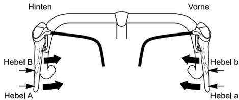
Hebel (A): Umschalten auf einen größeren Zahnkranz
