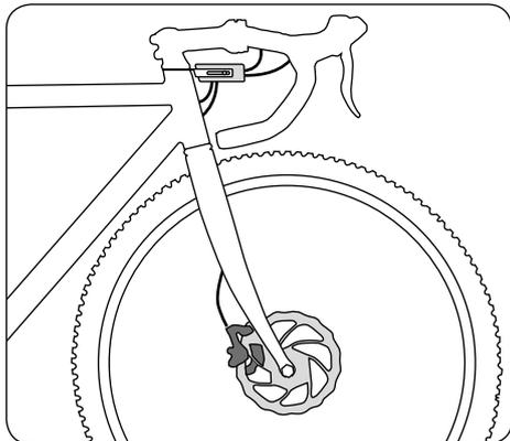
**i** Wenn Ihr Fahrrad mit einem Konverter ausgerüstet ist, der es ermöglicht, mit mechanischen Bremshebeln hydraulische Bremsen zu bedienen, lesen Sie vor Inbetriebnahme unbedingt die beiliegende Betriebsanleitung des Komponentenherstellers.
