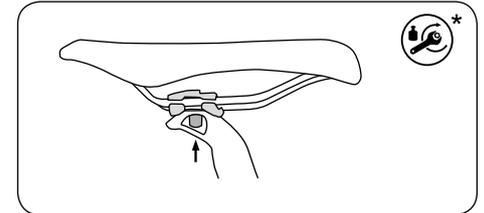
Patentstütze mit Einschraubefestigung
