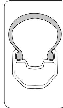
Schlauchlose Bereifung darf nur ohne Werkzeug montiert und von der Felge entfernt werden, andernfalls können in der Folge Undichtigkeiten auftreten. Falls die Dichtflüssigkeit nicht ausreicht, um einen Defekt zu verhindern, kann, nach Entfernen des Ventils, ein normaler Schlauch eingesetzt werden.
