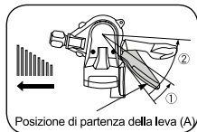
Cambio da un pignone posteriore più piccolo a uno più grande (leva A)
